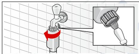
6. Очистите сетчатый фильтр на задней стенке прибора (для моделей Standard и моделей с системой Aqua-Secure):
